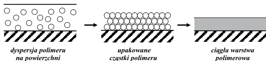
Rys. 2. Powstawanie ciągłej błonki polimeru, wg (3)
